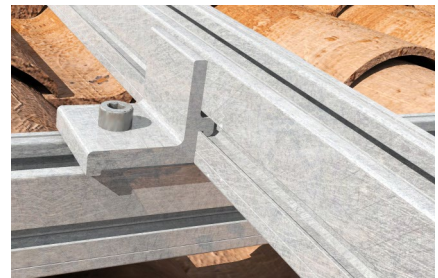
Detail křížového spojení
