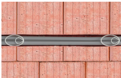
Zafixování kabelů v drážce o šířce > 30 mm
