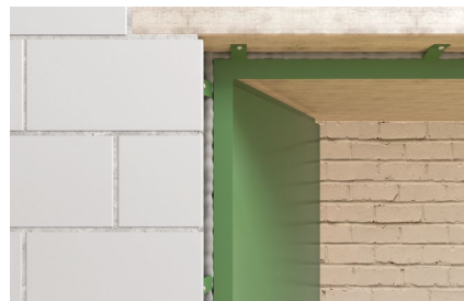
Vyplňování dutin v izolaci
